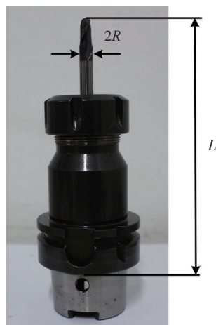
图11 刀具的长度和半径
